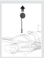
Achten Sie bei der Montage darauf, dass das Bugrad nach vorne zeigt.
